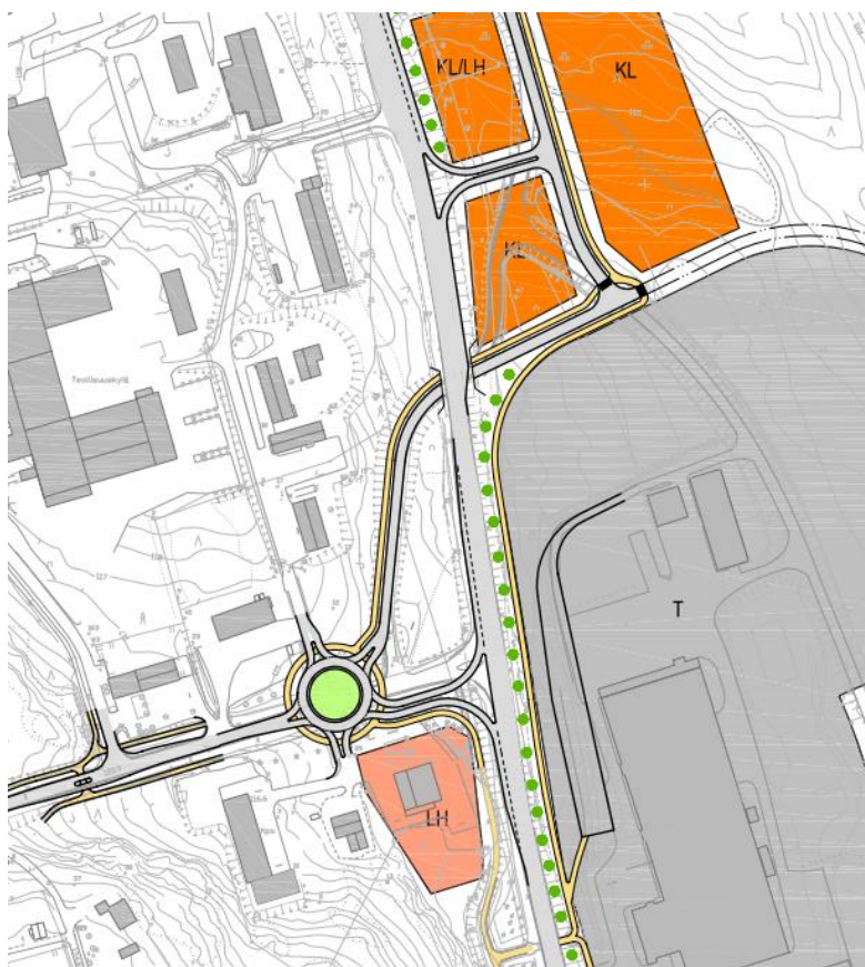
Kuva 6. Keskitien pohjoisen liittymä eritasoliittymäksi parantamisen jälkeen, kuva ohikulku- ja sisään-tulo-väyliä koskevasta selvityksestä (Tiehallinto, Keski-Suomen tiepiiri 2004).
