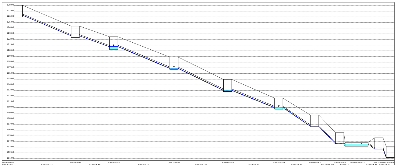
Kuva 13. Pituusleikkaus viivytyspainanteelle 3 johtavasta hulevesiverkostosta sadetapahtumalla 1/5 v 60 min.
